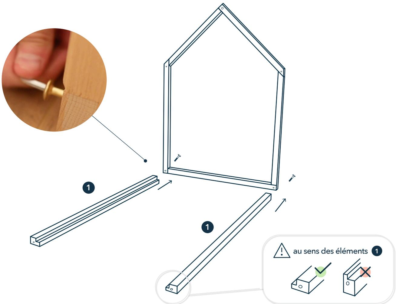
Figure 3 : Assemblage des faces latérales du lit cabane.
