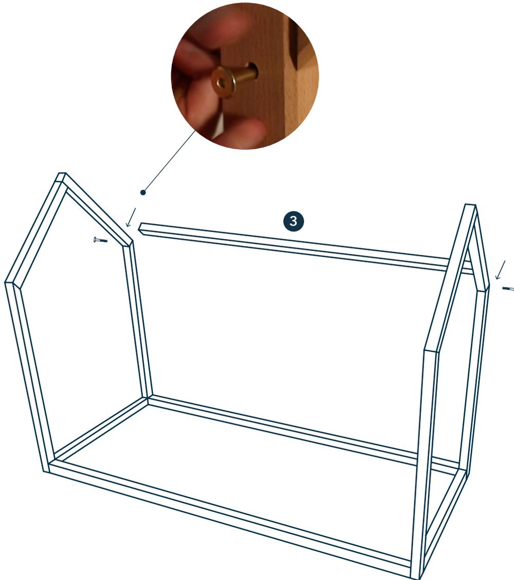
Figure 5 : Mise en place du premier élément 3.
