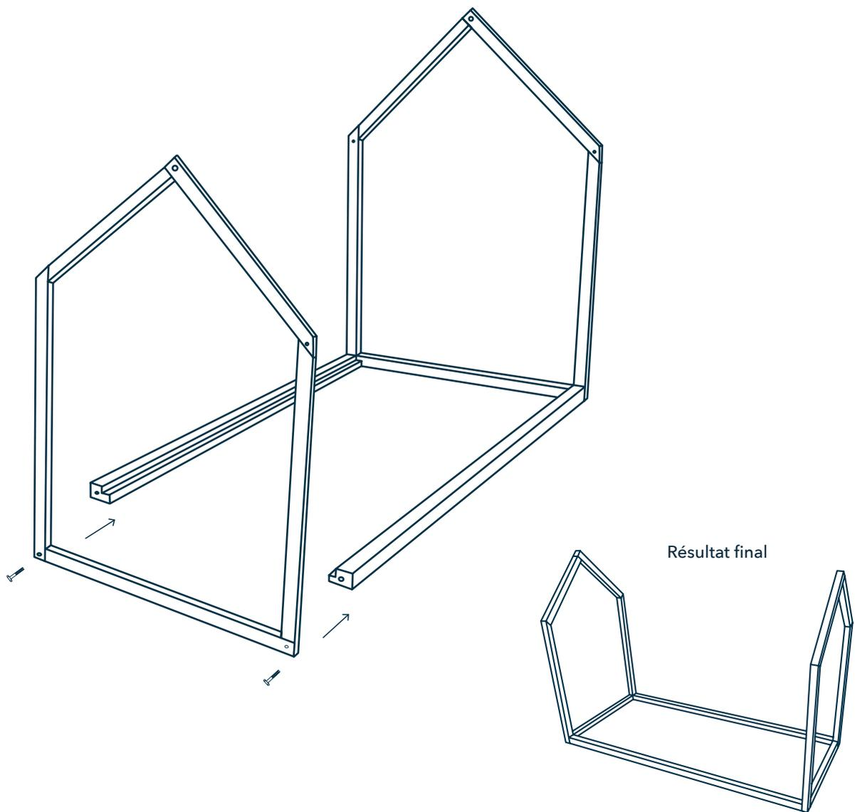
Figure 4 : Assemblage des faces latérales du lit cabane.
