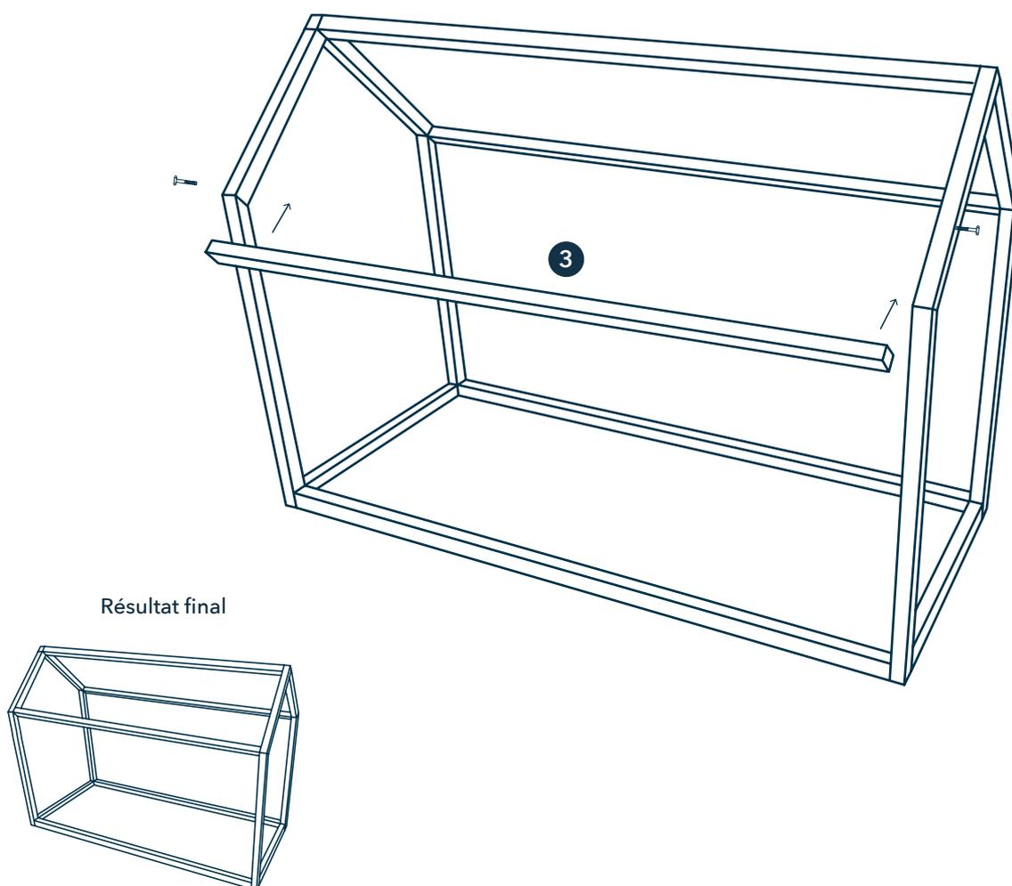
Figure 7 : Mise en place du troisième élément 3.
