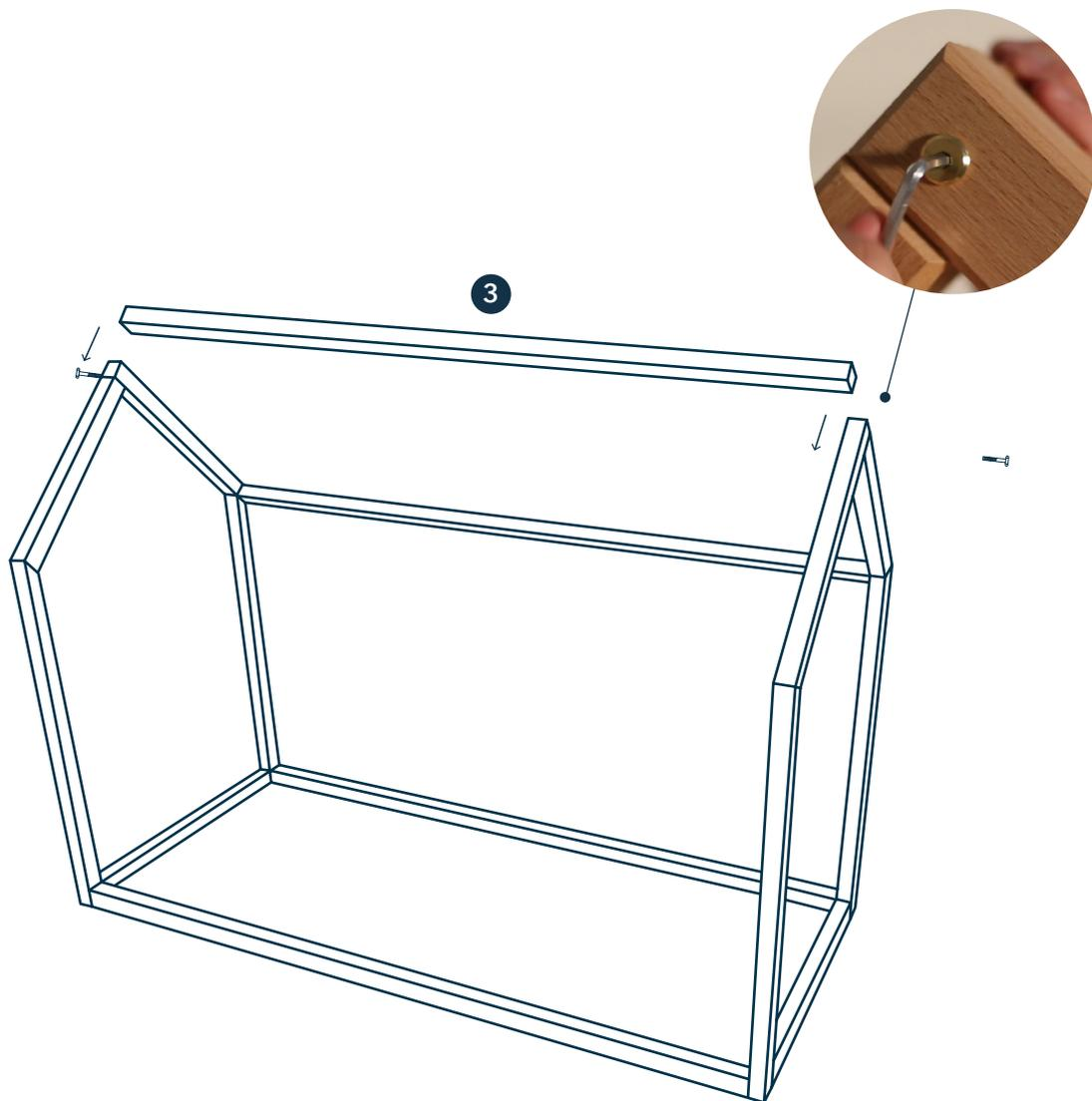
Figure 6 : Mise en place du deuxième élément 3.
